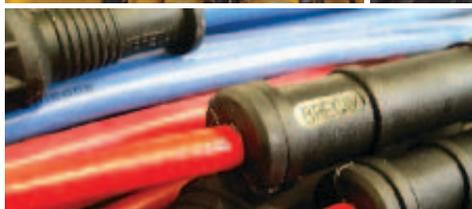
I cavi candela possono essere di tre tipi: cavi in rame con resistori nei connettori, cavi con resistenza al carbonio o cavi con reattanza induttiva (Mag-Wire). Ognuna di queste tecnologie ha caratteristiche che la rendono adatta a determinate applicazioni
